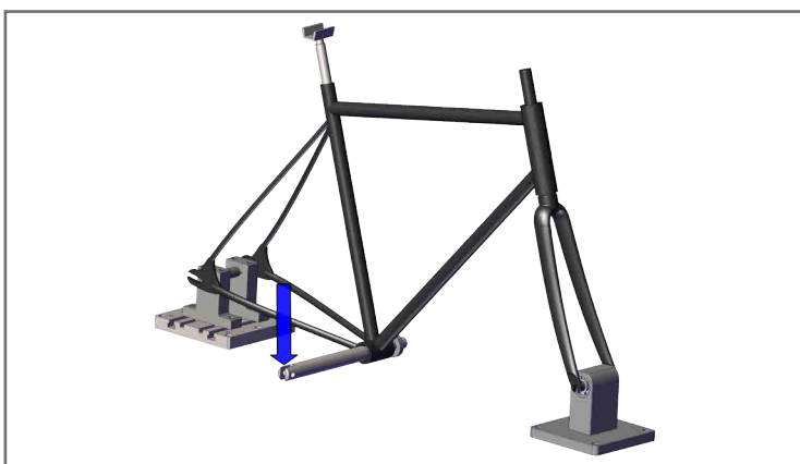
Prova di rigidità verticale su telaio
