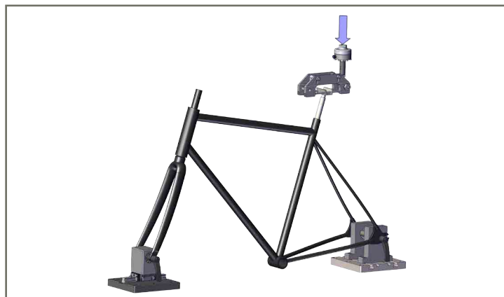
Prova di rigidità verticale su tubo sella
