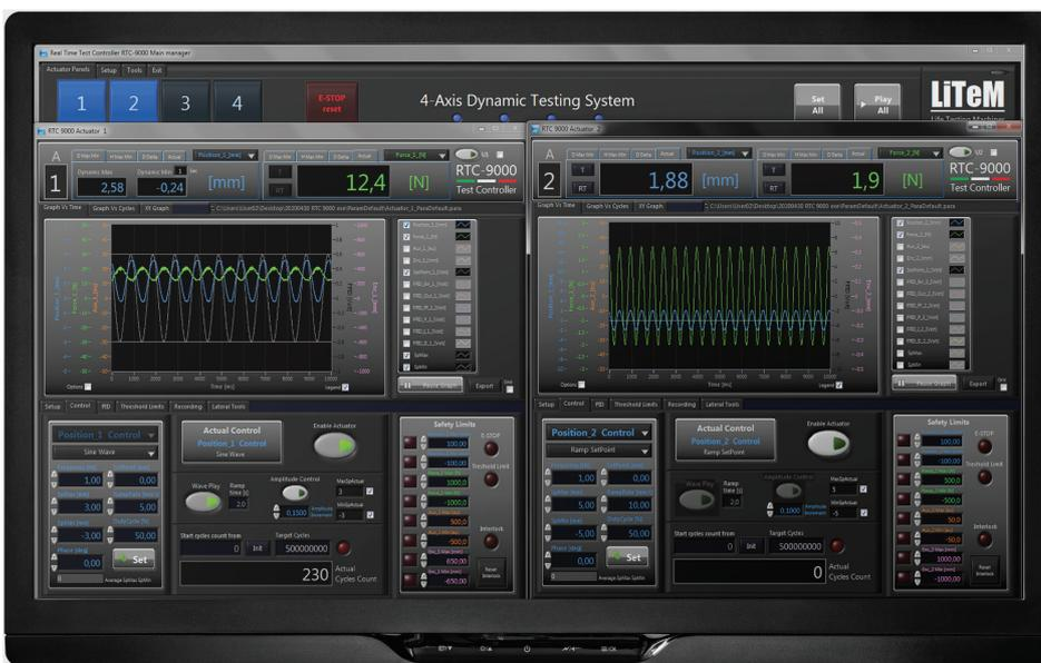
Visualizzazione di tutti i parametri di prova in un'unica schermata chiara ed intuitiva.
